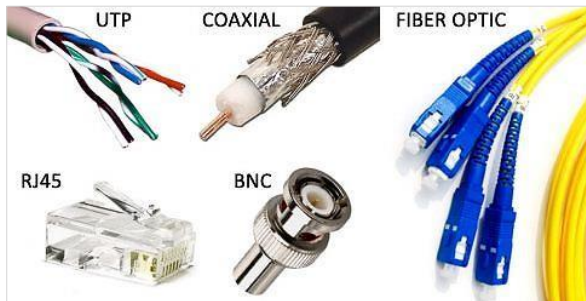
Gambar 2.5. Kabel dan konektor media transmisi berpemandu ( guided ) (Sumber: wikipedia.org)
