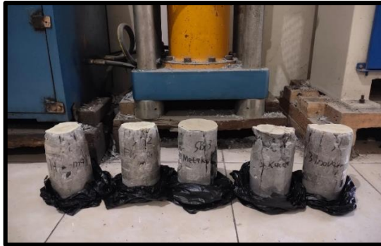
Gambar 1. Hasil Pengujian Sampel Beton Umur 28 hari
