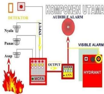
Gambar 21. Sistem Deteksi & Alarm Kebakaran
