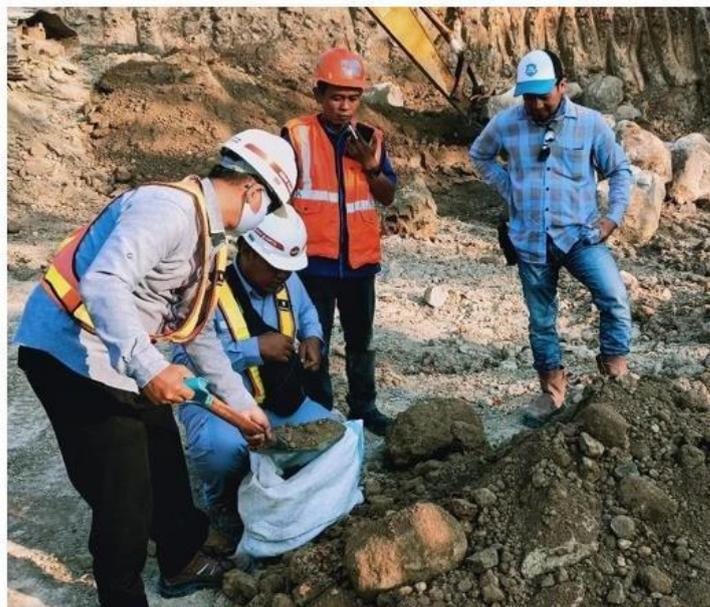
**Gambar 4. 8** Pengambilan sampel tanah di quarry
