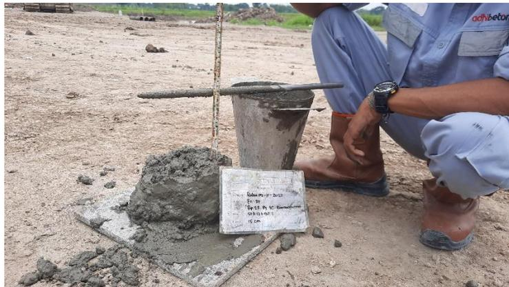
**Gambar 5. 26 Uji slump**
